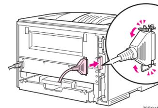
3 もう一方をパソコンのインターフェースコネクターに接続して、両側のネジをしめて固定します。
