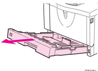
3 印刷する面を下にして A4 の用紙をセットします。
