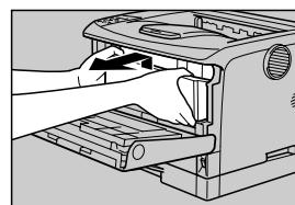
**3** 金属製のレジストローラーの位置を目安に、水を固く絞った布でレジストローラー周辺の紙粉を拭きとります。
