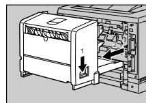
**6** 両面印刷ユニット底板のレバーを押し下げる(1)両面印刷ユニットを本機から引き抜きます(2)。
