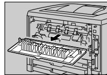
**5** 両面印刷ユニットを取り付けている場合は、両面印刷ユニット側面のレバーを押し下げ(1)、両面印刷ユニットを止まる位置まで引き出します(2)。
