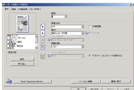
[基本]、[用紙]、[印刷品質]、[スタンプ印字] タブはプリンタードライバーの印刷に関する設定を行うタブです。このタブで行った設定が、すべてのアプリケーションで印刷するための設定の初期値になります。
