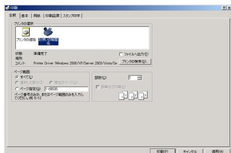
[全般]、[基本]、[用紙]、[印刷品質]、[スタンプ印字] タブには [プリント] ウィンドウから表示させた印刷設定の内容が初期値として表示されますので、アプリケーションからの印刷時は必要な項目を変更して印刷します。
