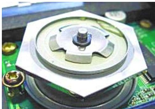
ポリゴンミラーが高速回転することで、光源から放たれたレーザービームを様々な方向へ照射することができます。ポリゴンミラーの働きによって、IPSiO SP 3100 のような小さなプリンタ内でも感光ドラムの左右方向へレーザービームを照射することができます。
