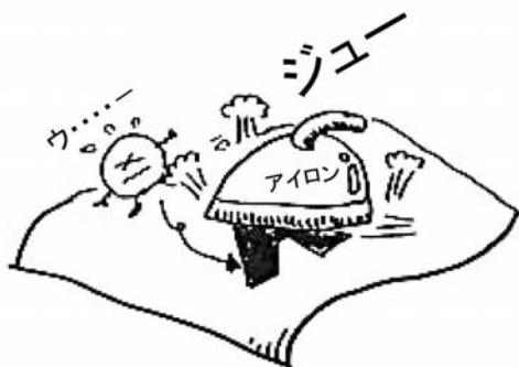
(実際にはローラーで圧力と熱を加えています。)
