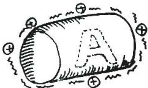
この感光ドラムに、帯電させたトナーを近づけると、感光ドラム上の電圧の低い部分（絵や文字になる部分）にトナーが移動します。これを「現像」と呼びます。（実際には、トナーが載っているローラーと感光ドラムが接触していて、ローラーと感光ドラムの電位差によりトナーが移動します。）
