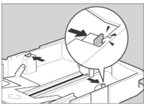
9 延長トレイを引き出した場合は、図に示した順序で給紙トレイカバー下部を少し引き上げ(①)、本機背面の給紙トレイカバーを取り外します(②)。
