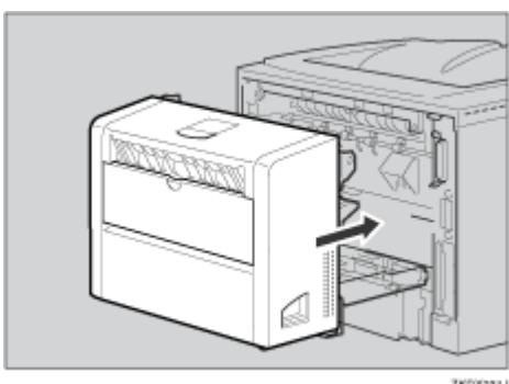
**25** 両面印刷ユニットをしっかりと本機に押し込みます。
