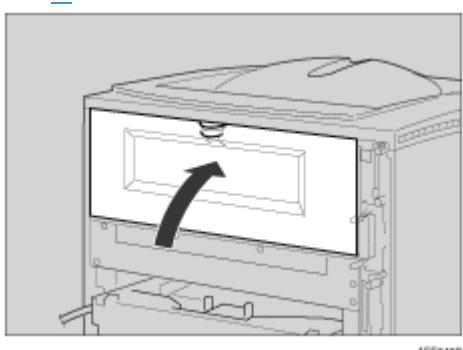
**24** 両面印刷ユニットを本機背面のレールに差し込みます。
