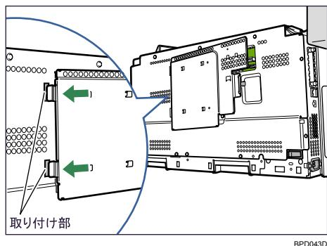
**16** 拡張メモリーユニットカバーを本機側へ押し込み(①)、左へスライドさせます(②)。
