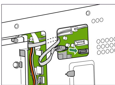
**14** 拡張HDDの電源ケーブルをコントローラーボードに取り付けます。
