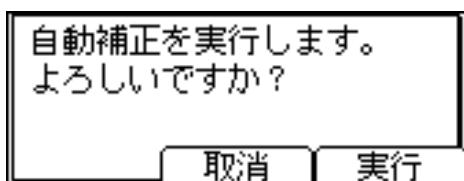
色ずれ自動補正の実行時間は約 50 秒です。自動補正が終了すると電源ランプが点灯します。
