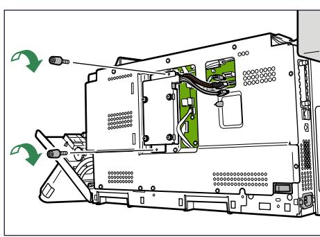
13 拡張 HDD のフラットケーブルをコントローラーボードに取り付けます。
