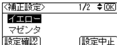
**13** [▲] [▼] キーを押して補正值を入力し、[OK] キーを押します。
