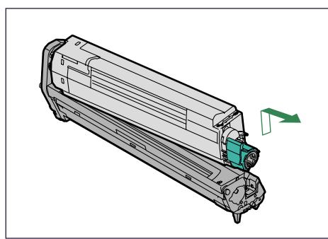
トナーカートリッジのレバーと反対側はドラムユニットのポスト（突起部）が差し込まれています。無理に持ち上げたり、引き抜くと、ポスト（突起部）が破損することができます。
