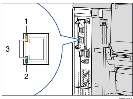
1 100BASE-TX 動作時は上側の LED が黄点灯します。
