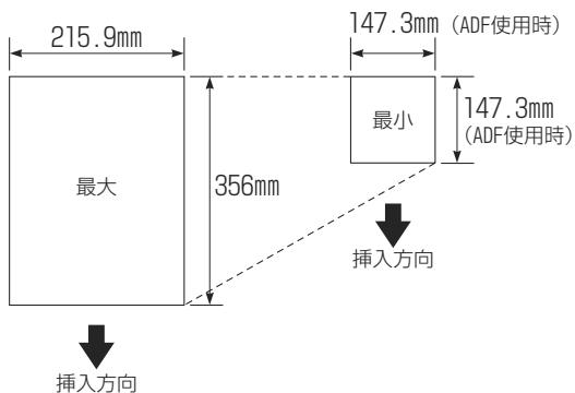
坪量 : 64g/m<sup>2</sup> ~ 90g/m<sup>2</sup> (ADF (自動原稿送り装置) 使用時)
