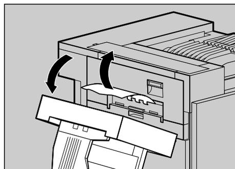
**5** 両面反転ユニットをゆっくりと起こしてカチッと音がするまで押し込みます。左カバーを起こし、「PUSH」シールの部分を押ししてしっかり閉めます。
