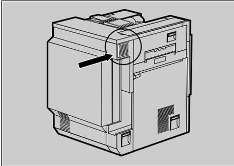
**1** 本機の電源を切り、電源プラグをコンセントから抜きます。
