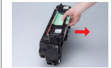
**8** 手順7で取り外した定着オイルユニットを、新しい定着ユニットの奥まで水平に差し込みます。
