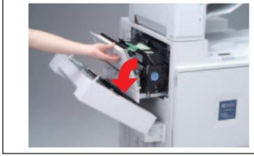
**5** レバーを押し下げて、定着オイルユニットを固定している取っ手を外します。
