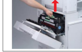
**7** 古い定着ユニットにセットされている定着オイルユニットを、水平に手前に引いて取り外します。
