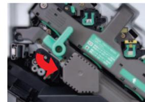
2 中カバーを固定している2ヶ所のねじを、付属の専用ねじ回しで反時計まわりにまわします。このとき、中カバーの中央部分を片手で押さえてまわしてください。
