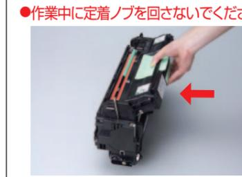
**9** 定着ユニットの取っ手を持ち、本体の受け台にあるマークと定着ユニットの形状が一致するように、垂直に定着ユニットをおろします。
