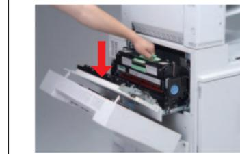
**10** 定着ユニットの取っ手を持ち、矢印の方向にカチッと音がするまで静かに倒します。
