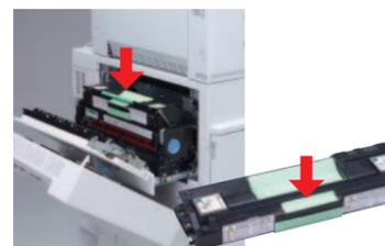
**6** 片手で定着ユニットの取っ手を持ち、もう一方の手で定着オイルユニットを水平に手前に引いて取り外します。
