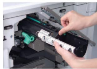
9 感光体ユニットの下部のカバーを取り外します。その後、正面を押し奥までゆっくりと差し込みます。
