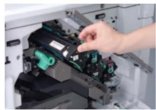
10 中カバーを閉め、上下2ヶ所のねじを専用ねじまわしで時計まわりにまわし、しっかり締めます。緑色のレバーを時計まわりにまわし、本体前カバーを閉めます。
