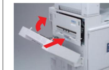
**12** 本体の左上カバーを閉め①、下部の取っ手を持って押し込みます②。その後、(両面印刷ユニットを取り付けているときは)両面反転ユニットを閉じます。
