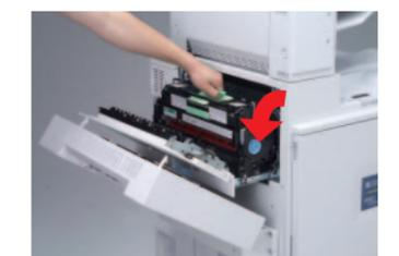
**4** 本体の左上カバーを閉め①、下部の取っ手を持って押し込みます②。その後、(両面印刷ユニットを取り付けているときは)両面反転ユニットを閉じます。
