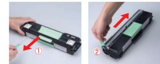
**2** 定着オイルユニットを持ち、もう一方の手で定着ユニットの緑色の取っ手を押さえて、矢印の方向にゆっくりと奥まで水平に差し込みます。
