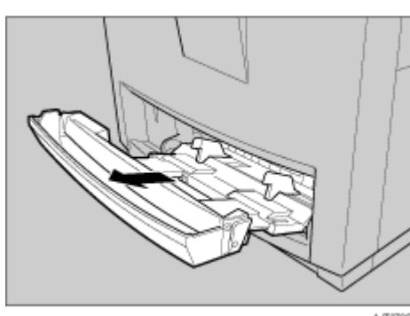
3 サイドガイドを広げ、印刷する面を下にして、用紙を先端が突き当たるまで差し込みます。
