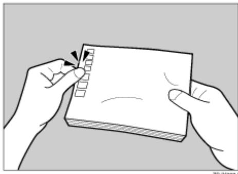
□ はがきの裏面にバリ（裁断したときにできた返し）があるときは、はがきを平らなところに置き、定規などを水平に1～2回動かしてはがきの4辺のバリを取り除き、バリを取り除いたときに出た紙粉を払います。
