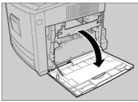
**4** 内部カバーを固定している左右のグリーンレバーをそれぞれ矢印の方向に外し、レバーのロックを解除します。
