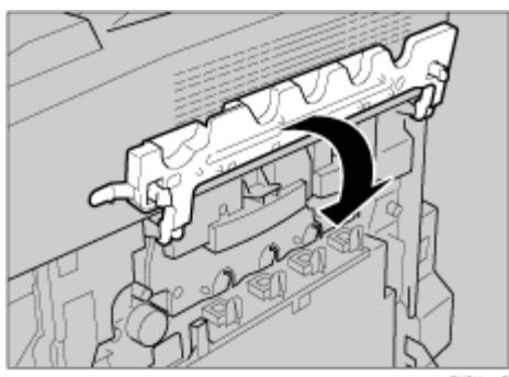
20 内部カバーの両端付近を押し、内部カバーを固定します。
