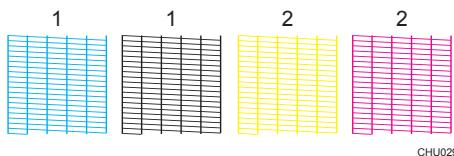
テストパターンでノズル抜けが発生したヘッドとその番号を確認します。
