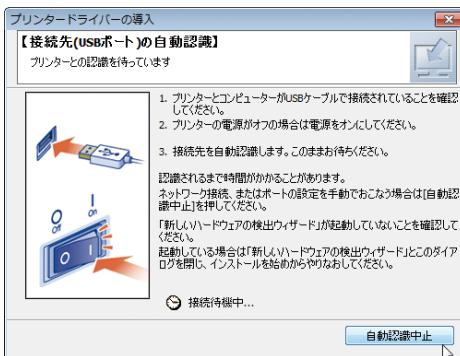
7. 本機とパソコンが正しく接続されていることを確認し、[電源] キーを押します。
