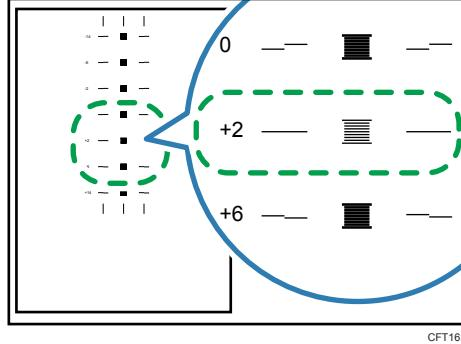
もっとも色の薄い四角であっても左右にある横線がずれているときは、その上または下のパターンで横線が逆方向にずれているものを参考にして、調整値を決めてください。たとえば、「+2」の四角の色がもっとも薄く、「+6」の左右にある横線が「+2」とは逆方向にずれているときは、調整値はずれの程度に応じて [+3] ~ [+5] になります。調整の終了後、もう一度用紙送り量調整をして、最適な調整値に設定されているか確認してください。
