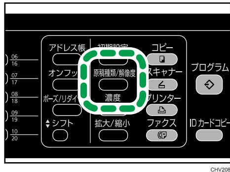
3. [▲] または [▼] キーを押して [原稿種類設定] を選択し、[OK] キーを押します。
