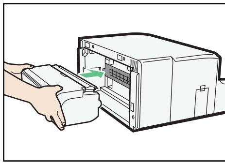
マルチ手差しフィーダーを取り付けるときは、電源が切れている状態でプリンター本体に取り付けます。
