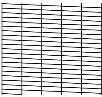
プリントヘッドにてノズル抜けが発生している場合
