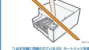
必ず本機に同梱されているGXカートリッジを使用して下さい。同梱品以外のカートリッジや使用済みのものを使用すると、インクを本体に送りこむ供給動作が正常に終了しないことがあります。
