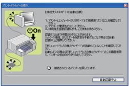
5 プリンターとパソコンが正しく接続されていることを確認し、操作部の[電源]キーを押します。
