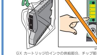
GXカートリッジのインクの供給部分、チップ部分には触れないでください。
