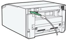
2 ケーブルのもう一方のコネクターをハブ（HUB）などのネットワーク機器に接続します。
